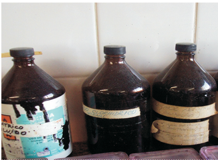
Falta de etiquetado de seguridad de productos químicos.
